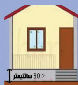
در صورت بارش زیاد باران و برف از یک لایه عایق رطوبتی در سطح پایه ستون استفاده کنید تا خاک تحدب (پی) در اثر رطوبت سست نشود
