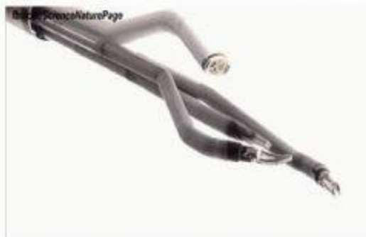
图表 8: 达芬奇手术机器人机械臂及手术器械
