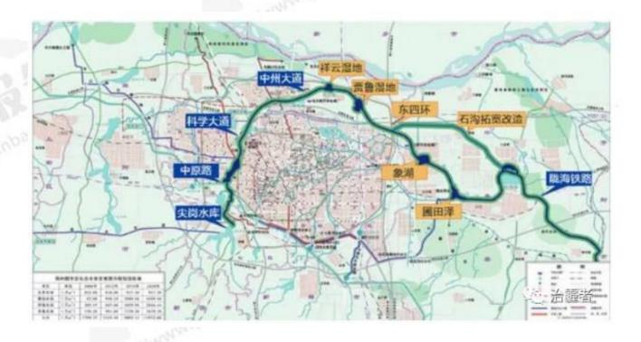
贾鲁河的最大流量是 1000 立方米/秒左右,与黄河可通过的 2 万立方米流量相差太大了。而贾鲁河上游的支流索须河汇入贾鲁河后,贾鲁河距黄河最近的距离不到 5 公里。因此,郑州市防洪最简单的办法就是把洪水抽到黄河河道里排放。
